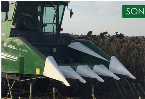
HALDRUP bietet verschiedene Möglichkeiten Sonnenblumen zu ernten. So zum Beispiel den Geringhoff Sonnenblumenpflücker oder die HALDRUP Sonnenblumenfinger, die einfach an das Standard Schneidwerk montiert werden können.
