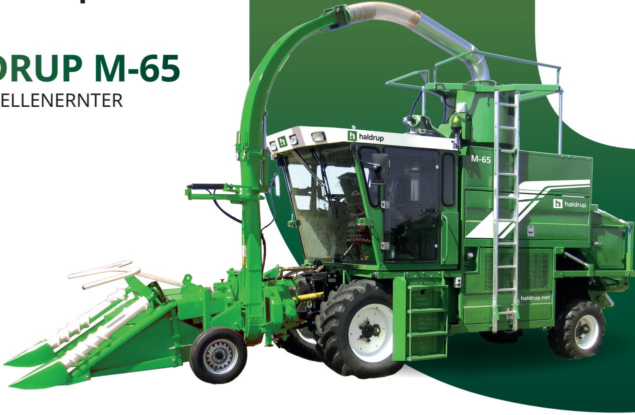
Der Maisparzellenernter M-65 ist eine wendige und kraftvolle Erntemaschine – konzipiert für Mais und Energiepflanzen. Deutz Motoren mit Turbo und Intercooler und bis zu 180 PS, Allradantrieb, Differentialsperre und große Räder garantieren Ihnen eine komfortable Ernte.
