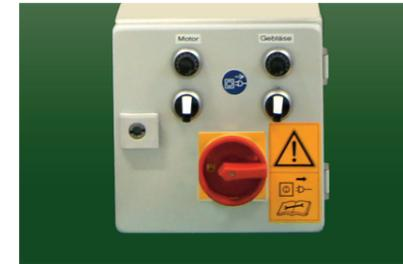
Die Gebläsegeschwindigkeit sowie die Drehzahl des Dreschwerks können stufenlos eingestellt werden.
