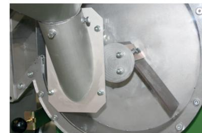
Durch die Klarsichtscheibe am Dreschwerk ist eine optimale Einsicht und genaue Kontrolle des gesamten Dreschvorgangs gewährleistet.
