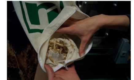
Staub, Spreu und Halmreste gelangen in den Spreusack. Alternativ kann eine Absauganlage angeschlossen werden.
