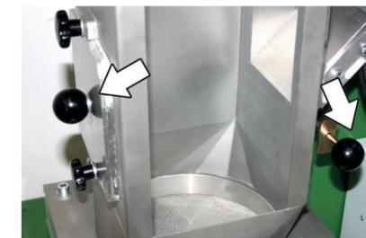
Durch eine durchdachte Konstruktion ist der einfache Zugriff in die Reinigungssäule gewährleistet.
