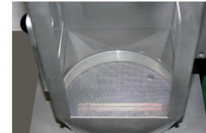
Die Klarsichtscheibe am Steigsichter gewährleistet eine hervorragende Einsicht und genaue Kontrolle des Reinigungsprozesses.
