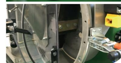
► Um den Arbeitsprozess zu optimieren kann mit einem Fußpedal die Dreschtrommel-Bodenklappe bequem geöffnet werden!
