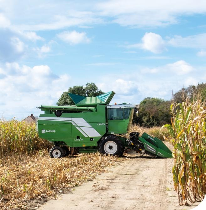
Das Erntegut wird pneumatisch in den 40-Liter-Vorbehälter des Wiegesystems gefördert, das unempfindlich gegenüber Erschütterungen ist. Eine Probenahme ist direkt aus der Kabine möglich.
